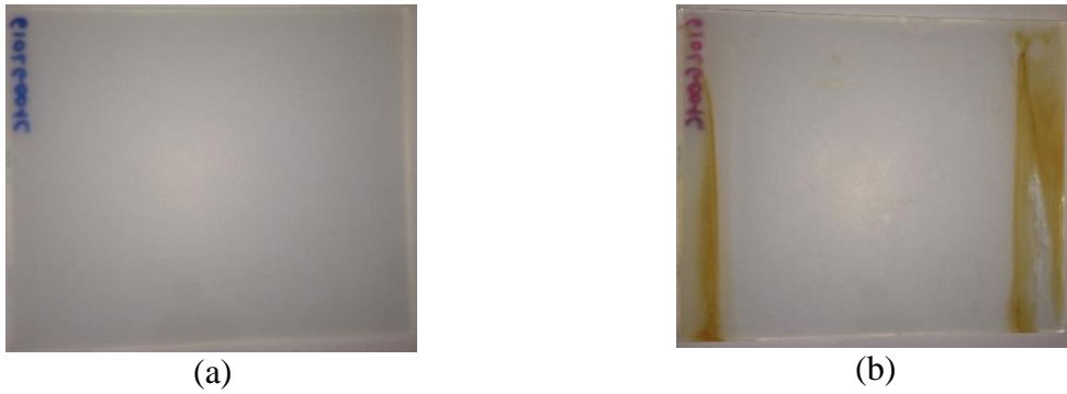
Figure 23 : (a) Plaque avant exposition et (b) plaque après exposition au \text{Ca(OH)}_2
