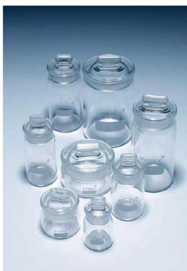
Figure 103 : Pèse-substance (à maintenir au dessiccateur, à nettoyer avec un pinceau prévu exclusivement à cet effet)
