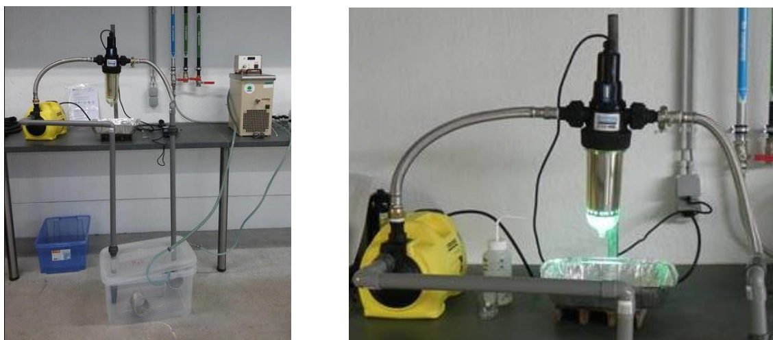
Figure 10 : Dispositif expérimental avec le système Cintropur
