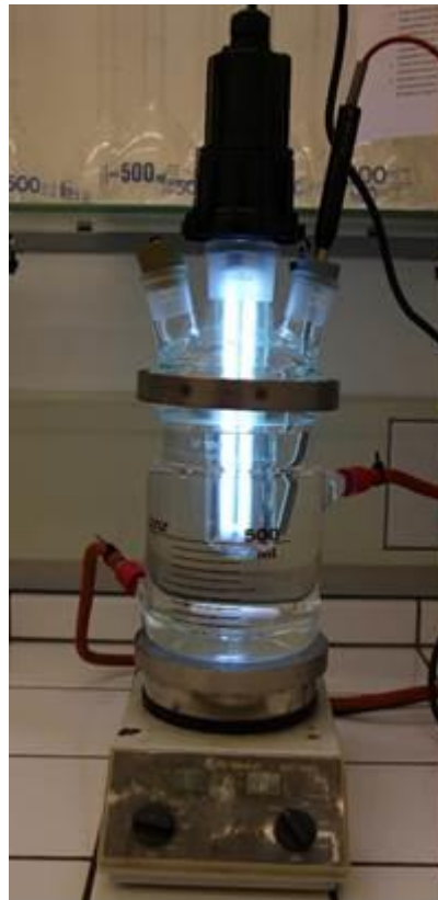
Figure 61 : Dispositif expérimental de photo(cata)lyse intermédiaire (batch)
